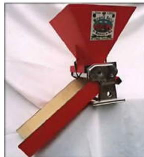
Si rimonta la macchina escludendo solo due lame che - nella parte inferiore - servono a ripulire i rulli dalla pasta. Si costruisce poi una tramoggia con del compensato da 5 mm, fissata al corpo macchina (ad esempio con due elastici ricavati da camere d'aria di bicicletta). Lo scivolo non è fissato, in quanto si appoggia nell'incavo sotto la testa della macchina e scende per gravità
